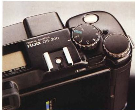
I comandi della Fujix DS-300 sono molto simili a quelli di una fotocamera tradizionale. Qui vediamo il pulsante di scatto e la ghiera dei modi operativi.
